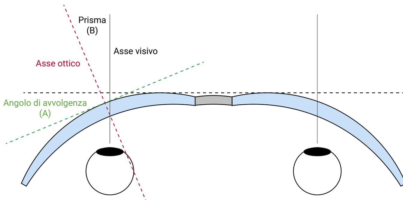
L'angolo A, dovuto alla particolare avvolgenza delle montature in base 8.00, crea l'angolo B, ovvero la differenza tra l'asse ottico delle lenti e il reale asse visivo. Questo genera un prisma con conseguenti problemi di visione (distorsioni e aberrazioni). Il nostro software NO PRISM è stato appositamente studiato per risolvere al meglio questo problema, compensando l'effetto prismatico grazie ad una particolare lavorazione atorica per una visione ottimale (C)
